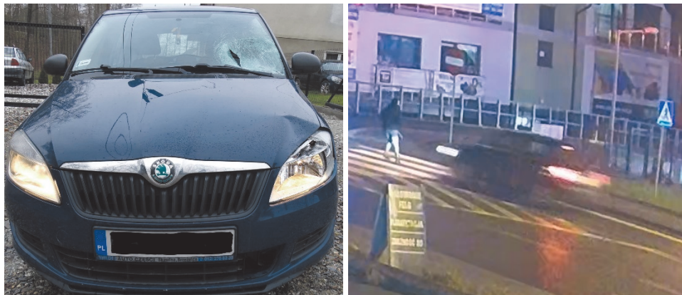
Ryc. 12. Obraz uszkodzeń samochodu Skoda Fabia oraz ustawienie pieszej względem pojazdu bezpośrednio przed potrąceniem.
