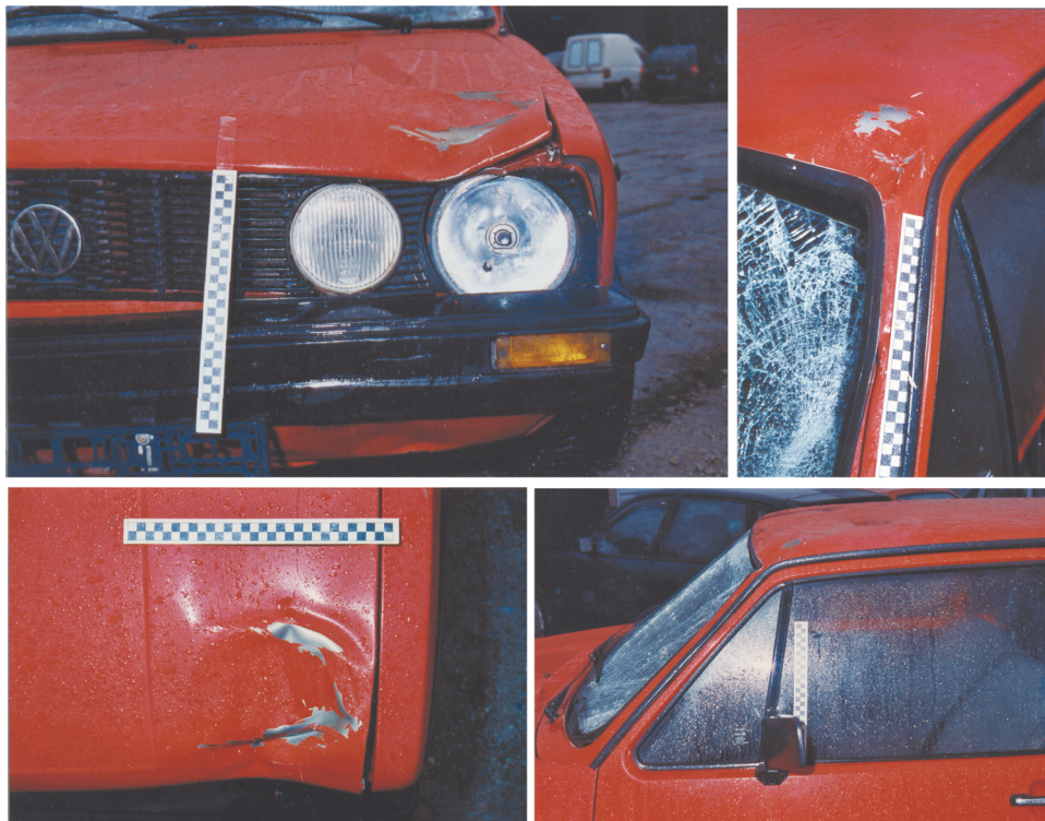
Ryc. 4. Uszkodzenia samochodu Volkswagen Golf powstałe w wyniku potrącenia pieszego.
