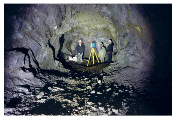
Fig. 3. TLS in adits of Riese, photo J. CeraRys. 3. Wykorzystanie technologii naziemnego skaningu laserowego w Riese, fot. J. Cera
