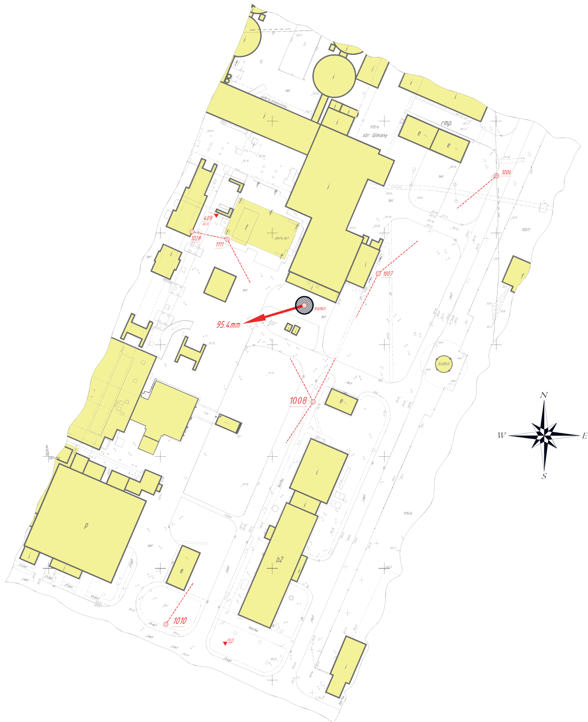
Fig. 3. Situation – altitude map of the industrial area in the vicinity of the inventoried industrial chimney of the Cement Plant „Ożarów” 1006, 1008, 1111 – measurement points; 1007, 1010, 1028 – situation reference points; 409 – altitude reference point. Distanced of measurement points from the measured chimney: 103.5m (point 1006); 43.4m (point 1008); 45.5m (point 1111). Rys. 3. Mapa sytuacyjno-wysokościowa terenu przemysłowego w otoczeniu inwentaryzowanego komina przemysłowego Cementowni „Ożarów” 1006, 1008, 1111 – stanowiska pomiarowe; 1007, 1010, 1028 – punktów nawiązania sytuacyjnego; 409 – punkt nawiązania wysokościowego. Odległości stanowisk od trzonu mierzonego komina: 103,5m (punkt 1006); 43,4m (punkt 1008); 45,5m (punkt 1111).
