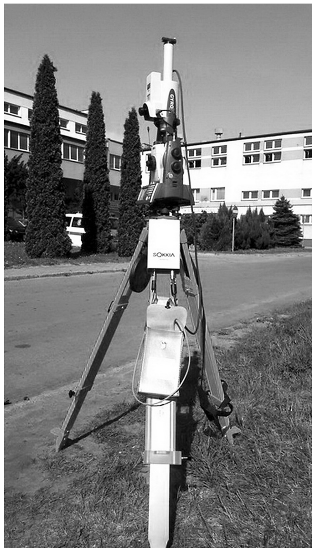
Photo. 1. The set of Sokkia gyroscope in Ruch „Borynia” Fot. 1. Zestaw giroskopowy firmy Sokkia w Ruchu „Borynia”
