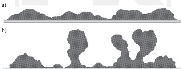
Rys. 1. Dwie struktury biofilmu powstałe w odmiennych warunkach: a) biofilm gładki (niskie stężenia substratów, duża szybkość ścinania), b) struktura nieregularna (wysokie stężenia substratów, mała szybkość ścinania)
