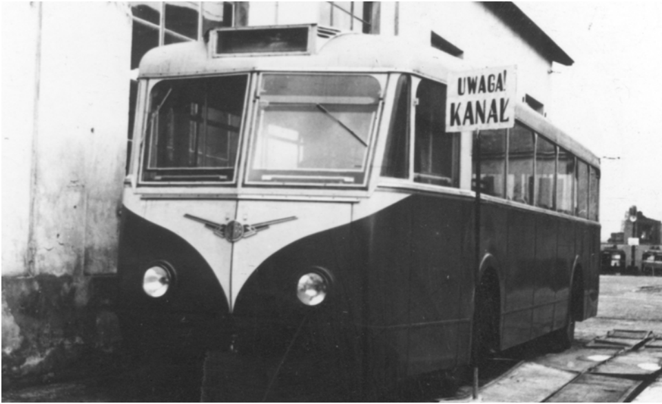
Ryc. 26. Nowoczesny trolejbus Vetra VBR h produkcji francuskiej. Pojazd ten uratował komunikację trolejbusową w Warszawie. Obok kanał rewizyjny przykryty blachami. Zdjęcie wykonane ok. 7 kwietnia 1948 r. (fot. NAC, sygn. 3-654.1).
