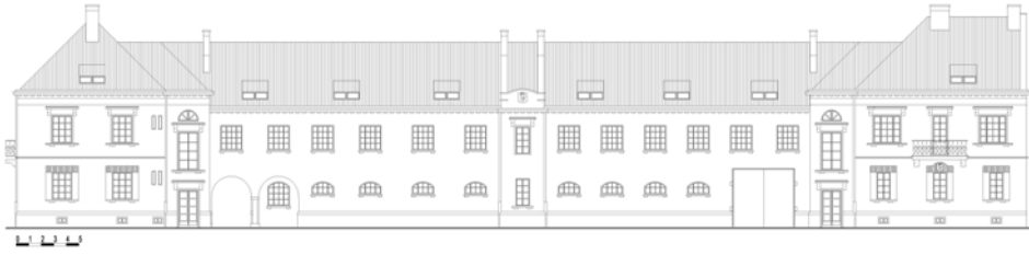
Ryc. 13. Zajezdni autobusowa Tramwajów i Autobusów Miejskich m.st. Warszawy ok. 1938 r. Widoczny jest udrożniony zachodni lewy półłuk i przebita duża prostokątna brama (rys. arch. inż. Anna Bojakowska).
