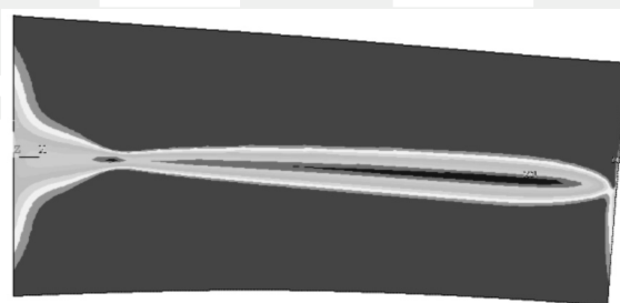
Rys. 5. Rozkład naprężenia zredukowanego wg hipotezy HMH
