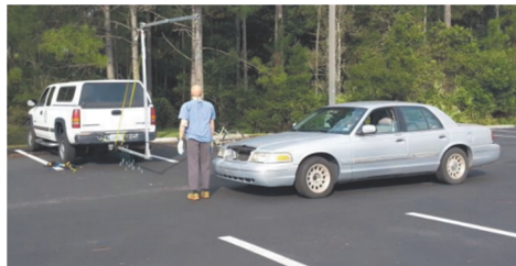
Ryc. 7. Badania amerykańskiej policji; nieokreślony manekin wykonany z tworzywa sztucznego, masa 22 kg, wzrost 178 cm) [2].
