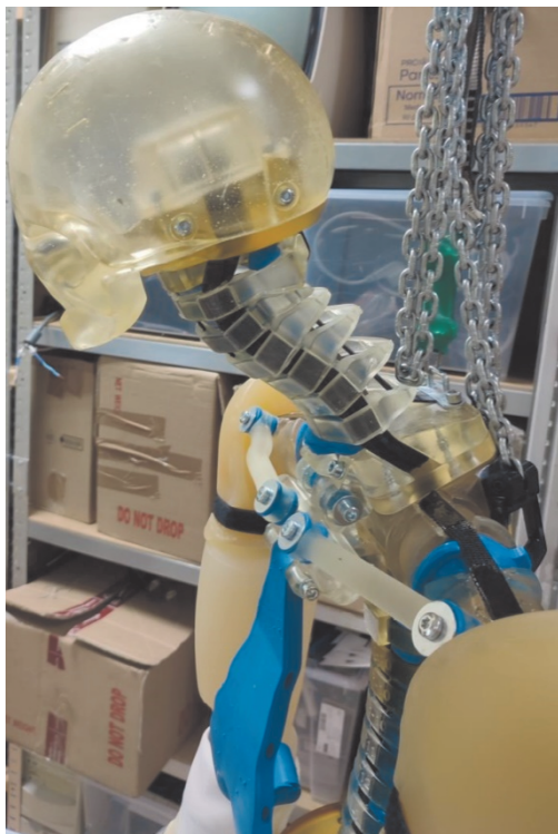
Ryc. 13. Odcinek szyjny kręgosłupa manekina PRIMUS. Źródło: zdjęcia własne CYBID.
