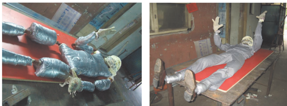
Ryc. 6. Nieokreślony manekin; najprawdopodobniej własna konstrukcja (członami ciała były worki z piaskiem oklejone taśmą klejącą) [3].
