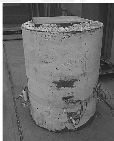
Rys. 3. Modele zaprojektowane do badań: a) rysunek, b) model podczas badań
