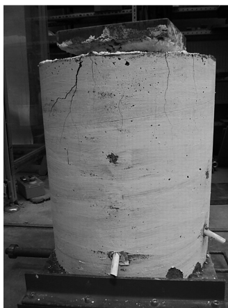
Rys. 17. Elementy nr 3 – widok elementu zniszczonego
