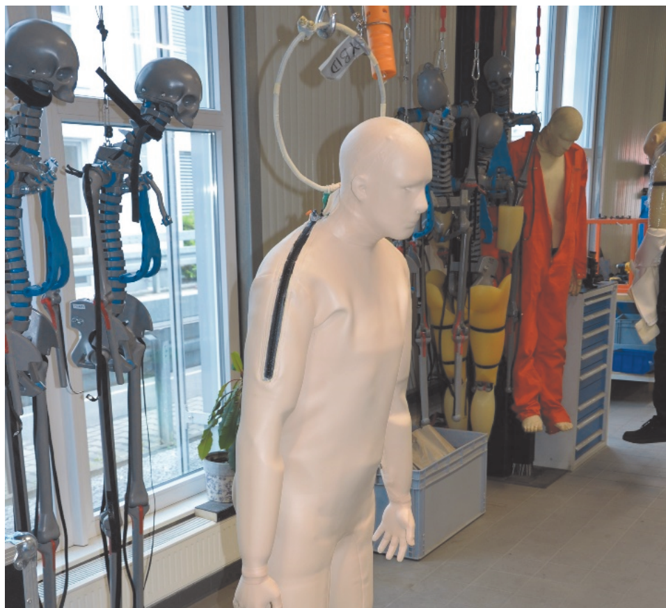
Ryc. 26. Manekin PRIMUS przeznaczony do walidacji programu V-SIM 5.0, a także dalszych eksperymentów.
