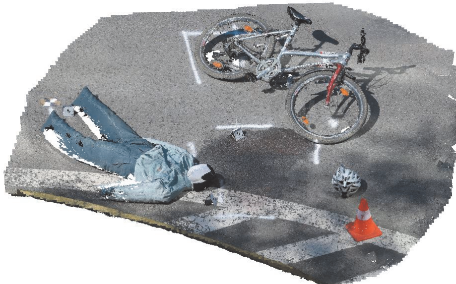
Ryc. 17. Odtworzenie pozycji ciała (manekin) za pomocą chmury punktów 3D utworzonej ze zdjęć wykonanych z drona.
