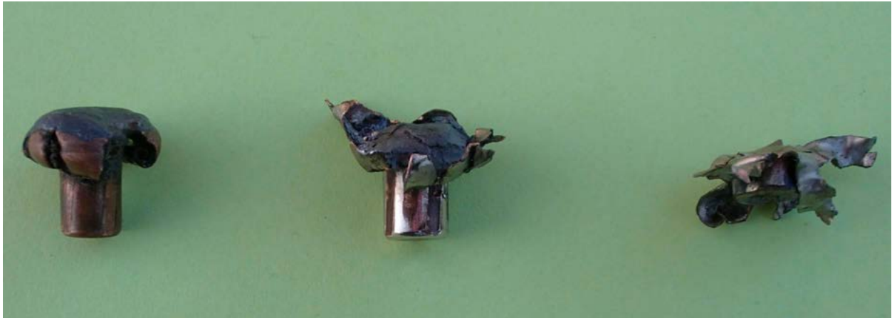
Ryc. 2. Pocisk z deformującą częścią głowicową (po lewej), pocisk rozrywający się połowicznie (w środku), pocisk ulegający całkowitej deformacji (po prawej)
