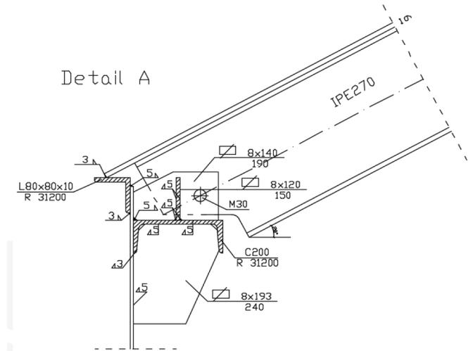
Fig. 1a) Detail A: upper ring
