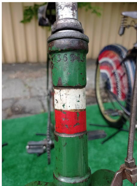
Ryc. 16. Główka późnego egzemplarza roweru „A. Kamiński” zbudowanego na ramie balonowej. Brak otworów nitów na emblemat, który zastąpiła kalkomania (fot. Ł. Kubacki; kolorowa ilustracja dostępna w elektronicznej wersji artykułu)
