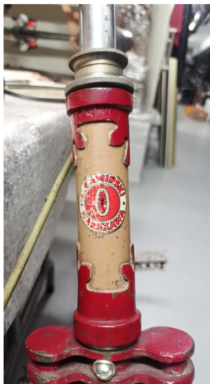
Ryc. 20. Detal główki ramy „wyścigowej”. Widoczny wysoki numer ramy 138072 oraz kalkomania firmowa, która latem (?) 1939 r. zastąpiła mosiężny emblemat (fot. Ł. Kubacki; kolorowa ilustracja dostępna w elektronicznej wersji artykułu).
