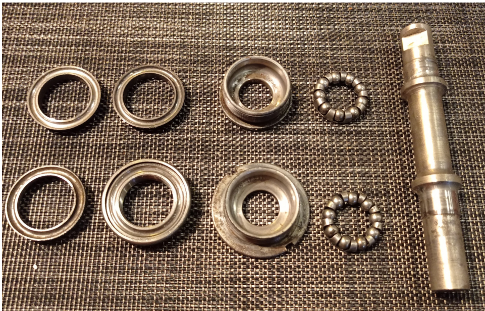
Ryc. 14. Przykład zintegrowanych sterów oraz miseczek suportowych firmy Brampton stosowanych często w rowerach „A. Kamiński” (fot. Łukasz Kubacki)
