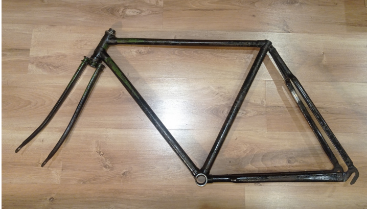
Ryc. 8. Rama roweru turystycznego B. Wahren „Syrena” z drugiej połowy lat dwudziestych XX w. Widoczne tylne haki wczesnego typu oraz przedni widelec półkowy z otworami na oś przedniej piasty zamiast łapek (fot. Ł. Kubacki; kolorowa ilustracja dostępna w elektronicznej wersji artykułu)
