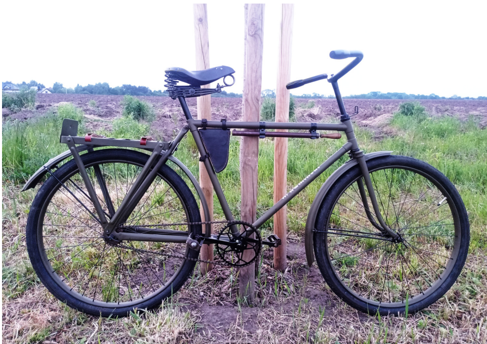
Ryc. 23. Rower wojskowy A. Kamiński zbudowany na ramie cywilnej (ze zbiorów autora, fot. Ł. Kubacki; kolorowa ilustracja dostępna w elektronicznej wersji artykułu)
