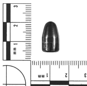
Ryc. 18. Ślady pól i bruzd lufy broni palnej pocisku pistoletowym (badania własne).
