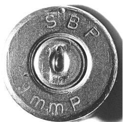
Ryc. 17. Charakterystyczne ślady na łusce odstrzelonego naboju (badania własne)
