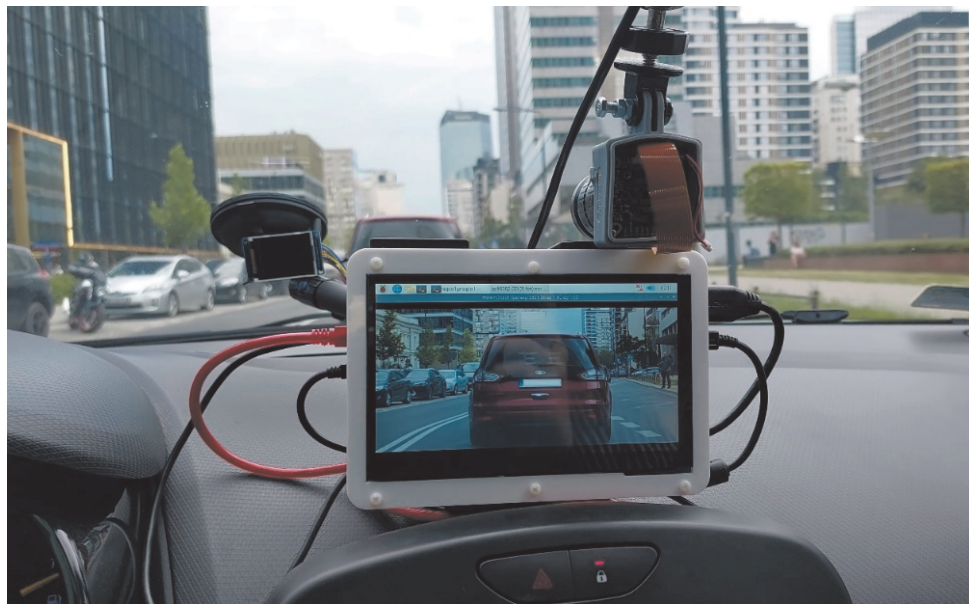
Ryc. 6. Wideorejestrator prędkości połączony z czujnikiem odległości.
