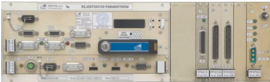
Ryc. 2. Rejestrator parametrów ATM-RPS4TU firmy ATM PP sp. z o.o. [6].
