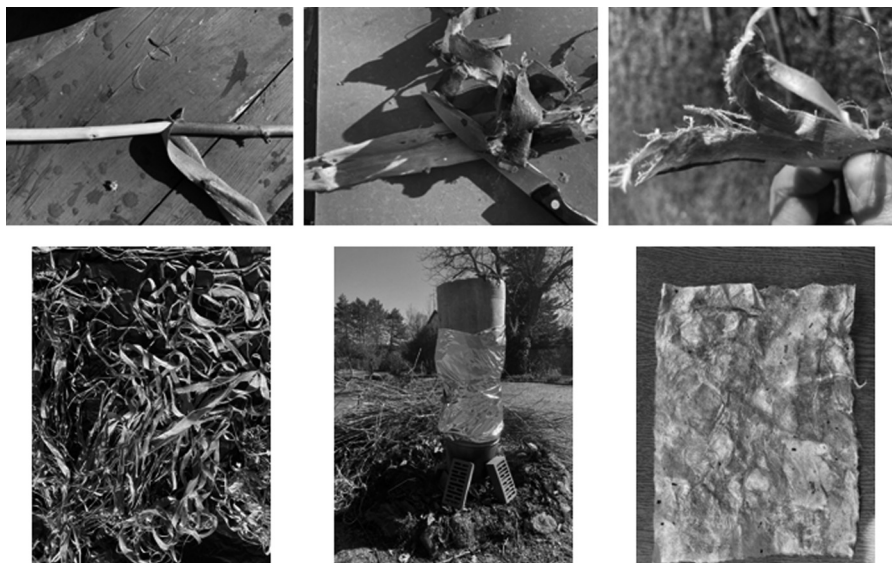
Rysunek 6. Produkcja papieru z morwy białej metodą wschodnią. Fot. M. Lorenc.
