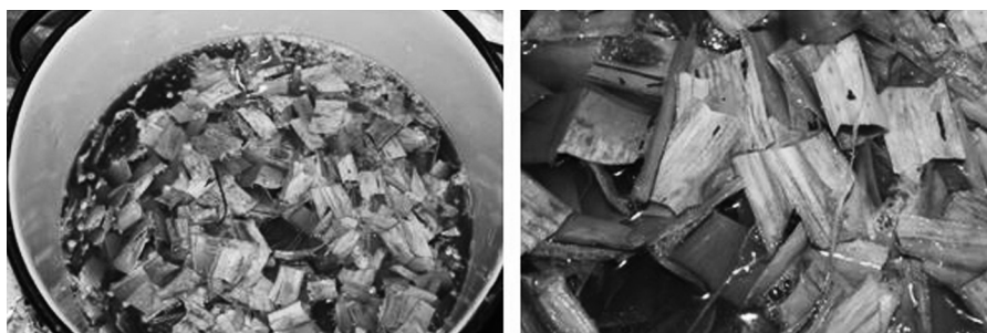
Rysunek 7. Włókna morwy papierowej podczas procesu ługowania. Fot. A.M. Brandys.
