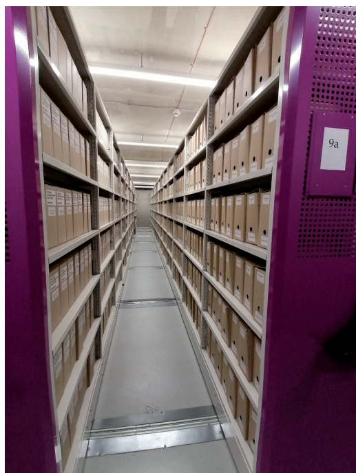
Il. 1. Przykład regału jezdnego, z regulowanymi półkami, zastosowanego do przechowywania materiałów archiwalnych w ANK, fot. Barbara Berska
