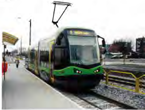
Fot. 7. Niskopodłogowy tramwaj Pesa 121N na nowym, otwartym 21.12.2006 r. torowisku w ul. Ogólnej
