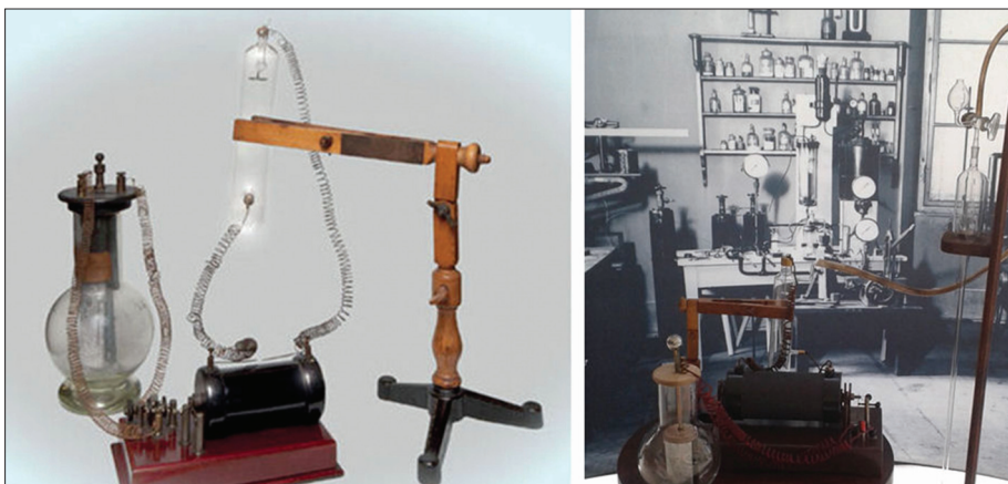
Il. II. Fotografie współczesnych rekonstrukcji zestawu, za pomocą którego Karol Olszewski wykonał pierwsze polskie zdjęcia rentgenowskie (po lewej w Muzeum UJ, po prawej w Katedrze Radiologii UJ CM). Fot. G. Zygier, fot. A. Urbanik
