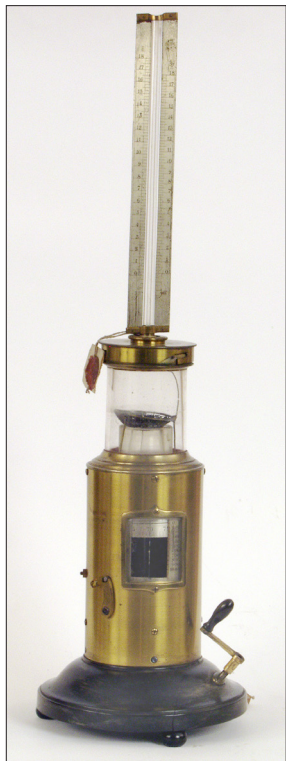
II. VII i VIII. Próbiez do oznaczania składu ilościowego aliażów drogich metali oraz rycina przyrządu. Własność Muzeum Uniwersytetu Jagiellońskiego w Krakowie
