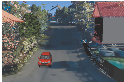
Ryc. 4. Chmura punktów z nałożoną teksturą, uzupełniona o modele 3D obiektów.
