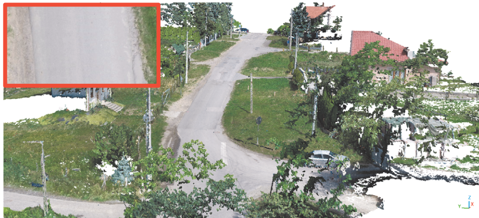
Ryc. 8. Chmura punktów uzyskana techniką fotogrametryczną (ok. 7500 pkt/m 2 ).
