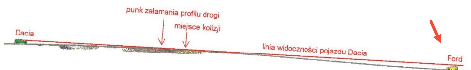
Ryc. 15. Linia widoczności poprowadzona od zagłówka przedniego fotela samochodu Dacia przez najwyższy punkt załamania profilu drogi. Odległość pojazdu Dacia od miejsca kolizji wynosi ok. 50 m. Pojazd marki Ford znajduje się poza polem widzenia kierowcy pojazdu marki Dacia.
