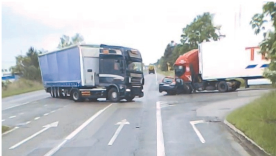
Ryc. 17. Początkowa faza uderzenia samochodu osobowego Volvo C30 w ciągnik siodłowy.
