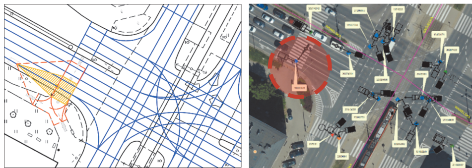
Ryc. 4. Analiza pól widoczności na analizowanym wlocie skrzyżowania przedstawionym na ryc. 3. Źródło: Iwanowicz D., Raport z audytu bezpieczeństwa ruchu drogowego na wybranych skrzyżowaniach z sygnalizacją świetlną m.st. Warszawa na drogach zarządzanych przez ZDM. Zarząd Dróg Miejskich Warszawa, 2023.
