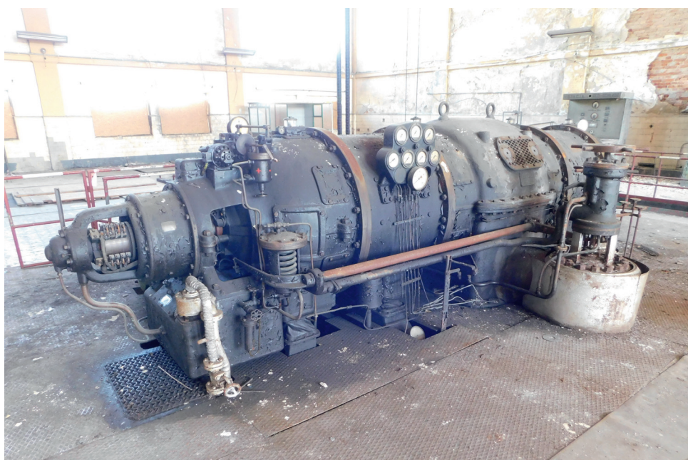
Ryc. 11. Turbina przeciwpężna firmy STAL z 1928 r. (fot. B. Kozak)
