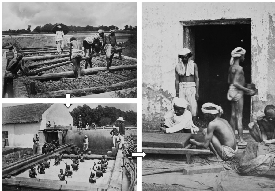
Rycina 3. Wytwarzanie indyga w Allahabad w Indiach (1877 r.): układanie roślin w kadziach, ręczne napowietrzanie kadzi, krojenie indyga. Fot. Oscar Mallitte.
