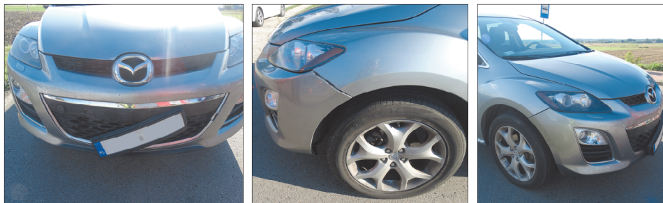
Ryc. 5. Uszkodzenia przodu nadwozia samochodu Mazda CX7, wynikające z uderzenia w tył poprzedzającego samochodu Skoda Rapid.
