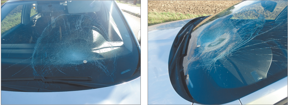
Ryc. 7. Uszkodzenia przodu nadwozia samochodu Skoda Rapid, będące skutkiem potrącenia pieszego.
