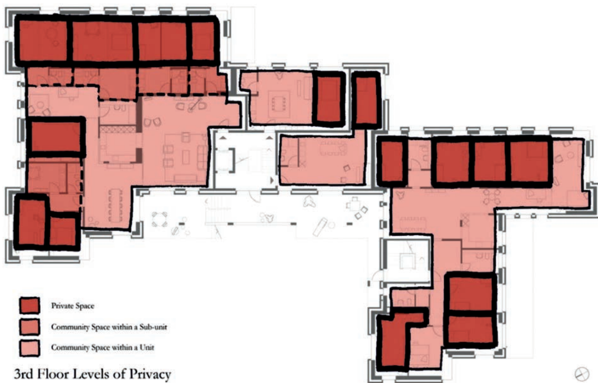
Il. 12, 13. Rozgraniczenie stref prywatnych, półprywatnych i publicznych na przykładzie parteru i trzeciego piętra / Levels of privacy in a referen- ce to a ground and third floor of the estate Źródło fotografii/Photograph source: https://regenerationstudio.weebly.com/uploads/2/3/3/0/23301256/655107_orig.jpg (dostęp/access: 29.04.2021) https://regenerationstudio.weebly.com/uploads/2/3/3/0/23301256/2653615_orig.jpg (dostęp/access: 29.04.2021)
