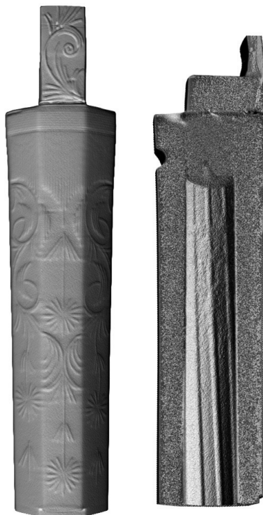
Il. 6. Trójwymiarowy model części dennej lufy (strzelba typu šišana, Turcja, XVIII/XIX wiek, nr inw. MNK V. 1462) uzyskany na podstawie tomogramów. Od lewej: widok zewnętrzny, następnie przekrój w płaszczyźnie stycznej przewodu lufy. Wyk. A. Tchórz
