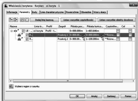
Rys. 7. Właściwości korytarza – okno dialogowe programu AutoCAD Civil 3D Fig. 7. Corridor properties – AutoCAD Civil 3D dialog box
