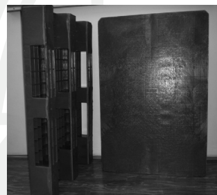
Rys. 4. Europalety z recyklatów polietylenu z 15% dodatkiem tufu [18]
