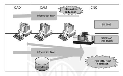
Fig. 1. Comparison of CNC machine tool programming with ISO 6983 and STEP-NC Rys. 1. Porównanie programowania OSN wg normy ISO 6983 i normy STEP-NC
