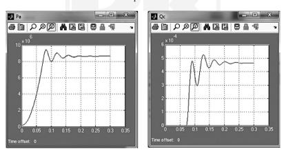
Fig. 6. Sparkline pressure  $p_a$  on input to the flow controller and course of the volumetric flow rate  $Q_c$  Rys. 6. Wykres przebiegu ciśnienia  $p_a$  na wejściu do regulatora przepływu oraz przebieg objętościowego natężenia przepływu  $Q_c$
