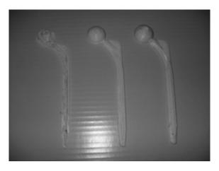
Fig. 7. Human hip joint endoprosthesis printout for various configurations of printing parameters Rys. 7. Widok modeli endoprotezy stawu biodrowego w zależności od konfiguracji parametrów drukowania
