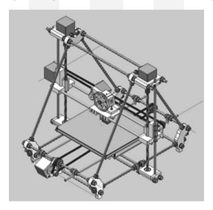
Fig. 6. The assembly of the 3D RepRap printer Rys. 6. Rysunek złożeniowy drukarki 3D typu RepRap
