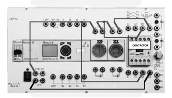
Fig. 5. The electrical connections of a latch circuit with STOP priority Rys. 5. Elektryczne podłączenie styku z podtrzymaniem z priorytetem STOP
