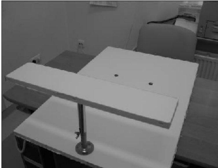
Rysunek 1. Przyrząd służący do adaptacji pryzmatycznej
