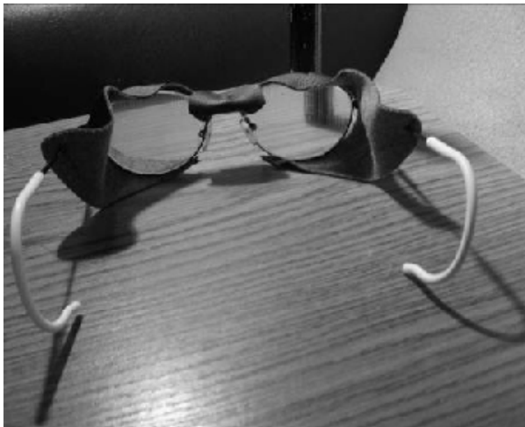
Rysunek 2. Przesunięcie obrazu wzrokowego za pomocą gogli pryzmatycznych
