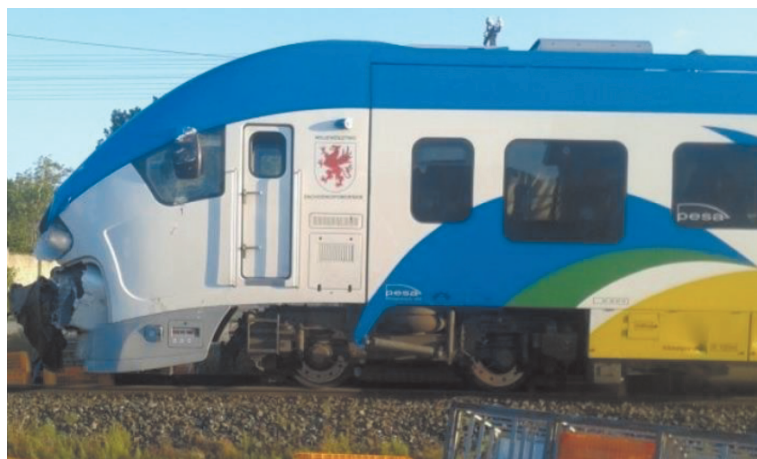
Ryc. 5. Uszkodzenia szynobusu PESA.
