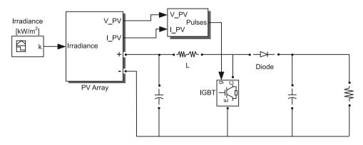
Fig. 2. PV array circuit with MPPT algorithm control in resistance load conditions Rys. 2. Bateria ogniw PV ze sterowaniem algorytmem MPPT w warunkach obciążenia rezystancja
