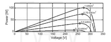
Fig. 3. Set of power-voltage characteristics of PV array for various irradiance conditionsRys. 3. Bateria ogniw PV ze sterowaniem algorytmem MPPT w warunkach obciążenia rezystancją
