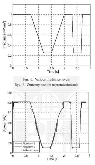
Fig. 7. Level of power produced by PV array Rys. 7. Poziom mocy produkowanej przez baterię PV
